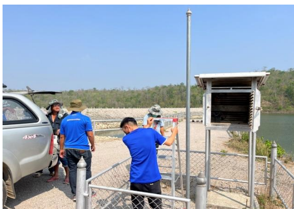
รูปที่ 5.2.1 – 10 การตรวจสอบเครื่องวัดปริมาณน้ำฝน
