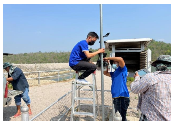
รูปที่ 5.2.1 – 10 การตรวจสอบเครื่องวัดปริมาณน้ำฝน
