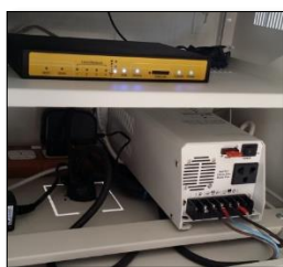
รูปที่ 5.2.5 – 3 อุปกรณ์รับส่งข้อมูลแผ่นดินไหว ผ่านระบบสัญญาณอินเทอร์เน็ต และระบบพลังงาน และอุปกรณ์ตรวจวัดค่าอัตราเร่งของพื้นดิน (Accelerograph)
